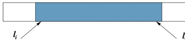
Si la lista mantiene sólo un extremo móvil, o sea la lista es estable (anclada en un extremo), basta con mantener en el descriptor el límite superior junto con la dirección física de inicio del trozo correspondiente.
